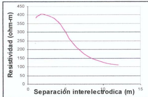
Figura 5.16.- Curva de R vs D resultante de las mediciones del terreno en Enero 2001. Fuente: Informes Técnicos.
